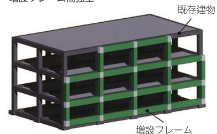
デザインUフレーム工法 増設フレーム補強型
