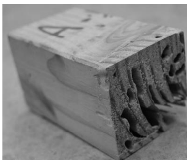
図2 内部のみ劣化した部材
