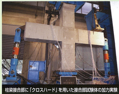
柱梁接合部に「クロスハード」を用いた接合部試験体の加力実験
