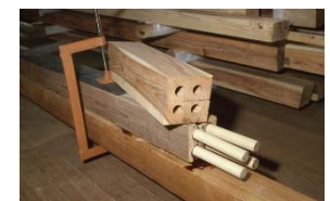
図 5. 合成樹脂の使用 (部材の充填、開発された新しい根継)「斎藤資料」より
