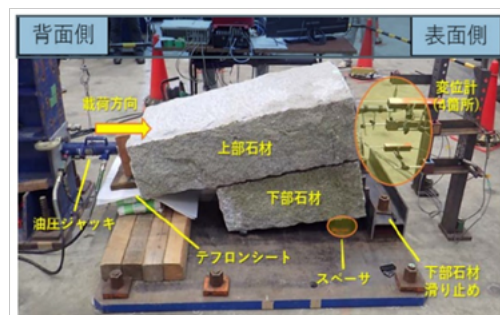
写真-1 逆石の摩擦抵抗試験 2)
