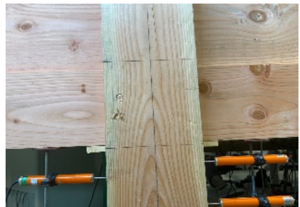
写真 4 接合部回転角が 1/75\text{rad} 時の状況
