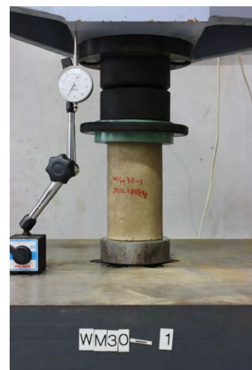
図3. 圧縮試験のセットアップ概要
