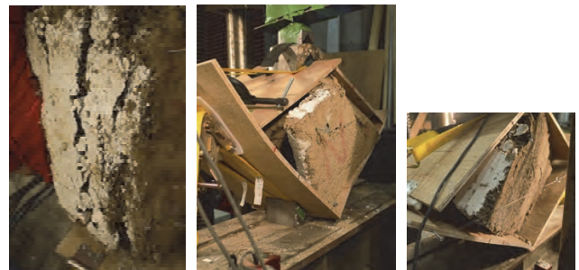
(a)断面の剥離 (b)外壁面の剥離 (c)内壁面の剥離
