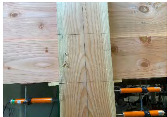
写真4 接合部回転角が 1/75\text{rad} 時の状況
