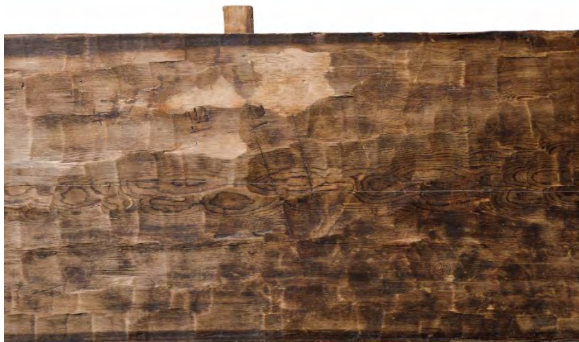
図6 西大寺食堂院から出土した井戸枠に残る加工痕跡 1:10
