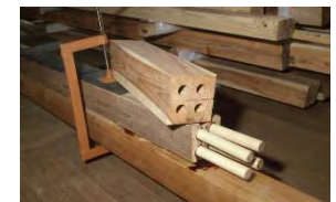
図 5. 合成樹脂の使用 (部材の充填、開発された新しい根継)「斎藤資料」より
