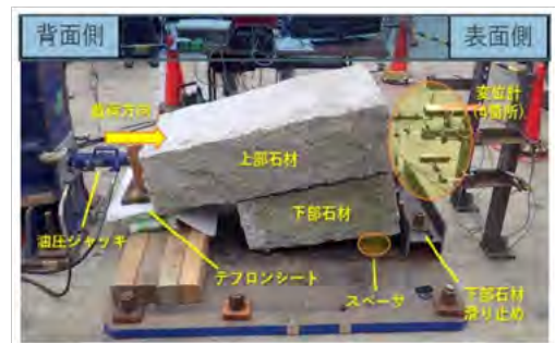
写真-1 逆石の摩擦抵抗試験 2)
