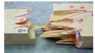
(a) 貫の曲げ破壊
