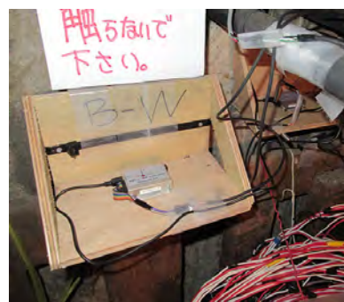
写真 2.5 旧小樽倉庫に設置した地震計 (MEMS 加速度センサー)
