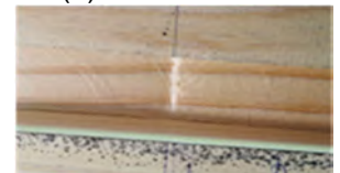
(b) 板材端部のめり込み 図 4 破壊性状
