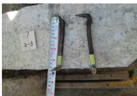
写真 3.8 木柱と石壁を接合する軟鋼製鋕
