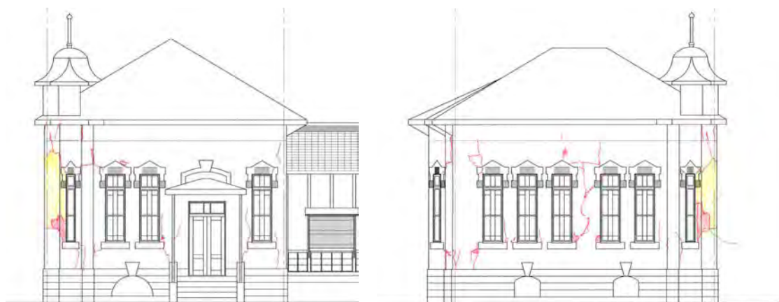
図 3.1 2022 年 3 月 16 日福島県沖地震による奥山家住宅洋館の被害状況
