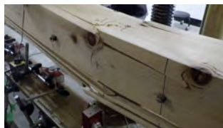
(a) 曲げ破壊 (M 試験体)
