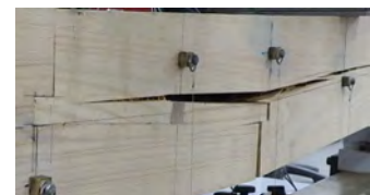
(f) 腮から目違いにかけての割裂 (MJ 試験体)
