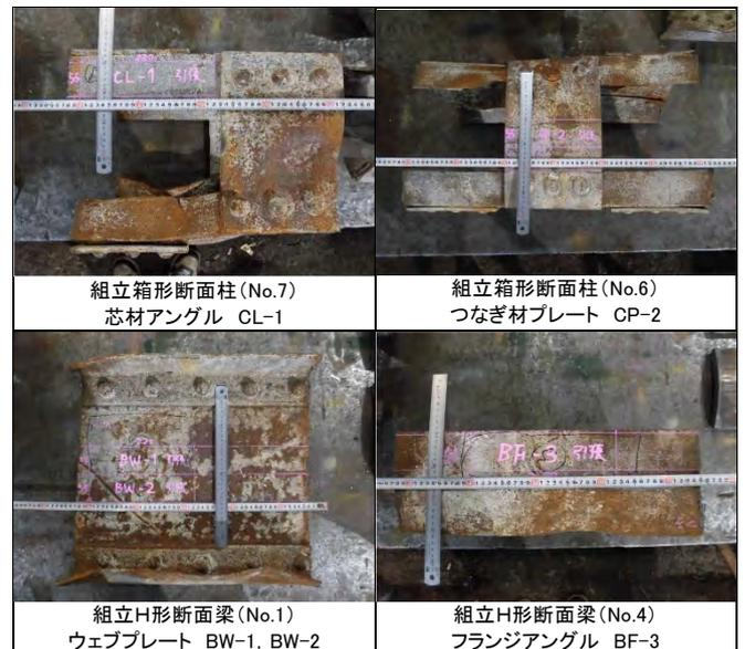
写真 2 試験片の採取位置
