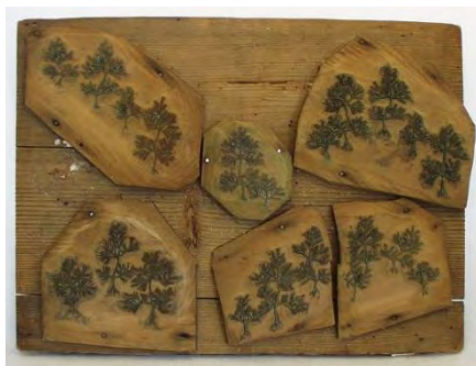
図 2-2-2-4 改造板木 (1 枚の板木を分割し異なる配置としたもの、 あるいはヤキモチ板を張り付けて 1 枚の板木としたもの : 10 枚張り)
