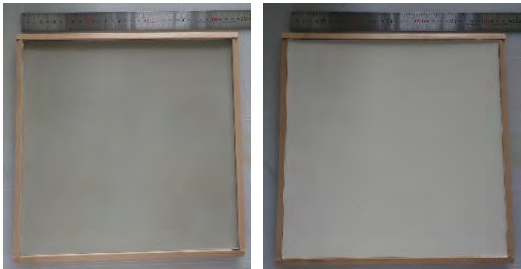
図 3 試験体（左：並大津壁、右：しっくい壁）
