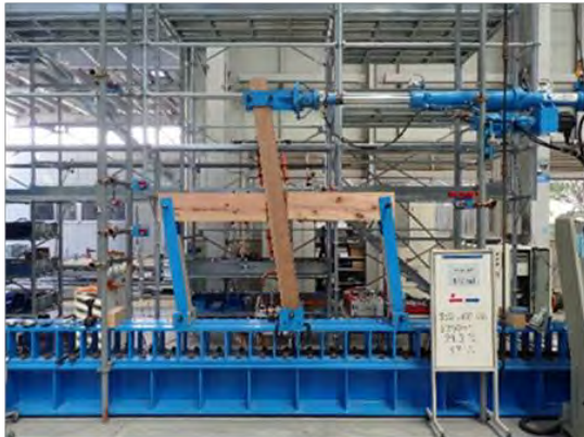
写真 1 竿車知仕口試験体の実験の状況
