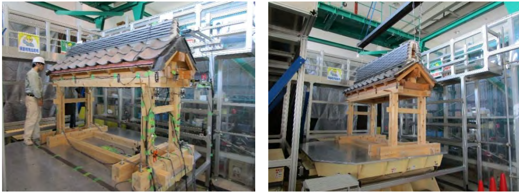
図5 試験体全景と振動台設置状況（左：棟なし、右：棟あり）
