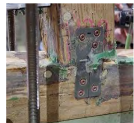
図 21 破壊性状 (めり込み)
