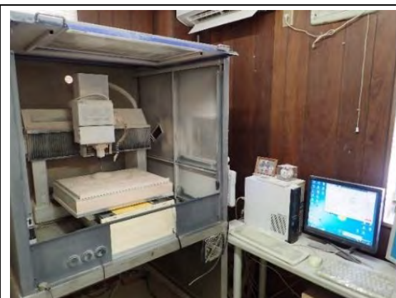
木地模刻資料を作製した5軸自動切削装置
