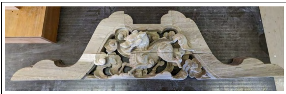
三次元計測データをもとに製作した機械切削技術による白木状態の木地模刻資料
