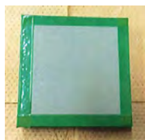
図5 試験体片(大津壁)
