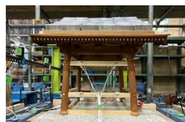
図 15 鐘楼の縮小模型 (1/10 縮尺)
