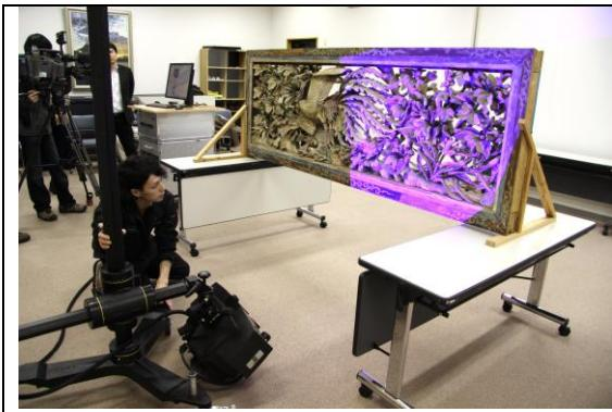
図 1-1:瑞巌寺本堂彩色欄間の三次元レーザ計測風景
