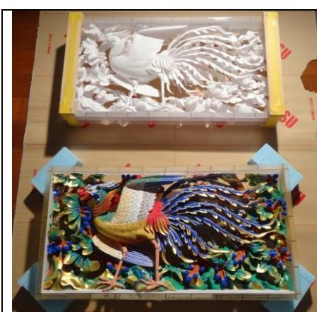
図 1-6:複数作製可能な光造形樹脂レプリカの実例
