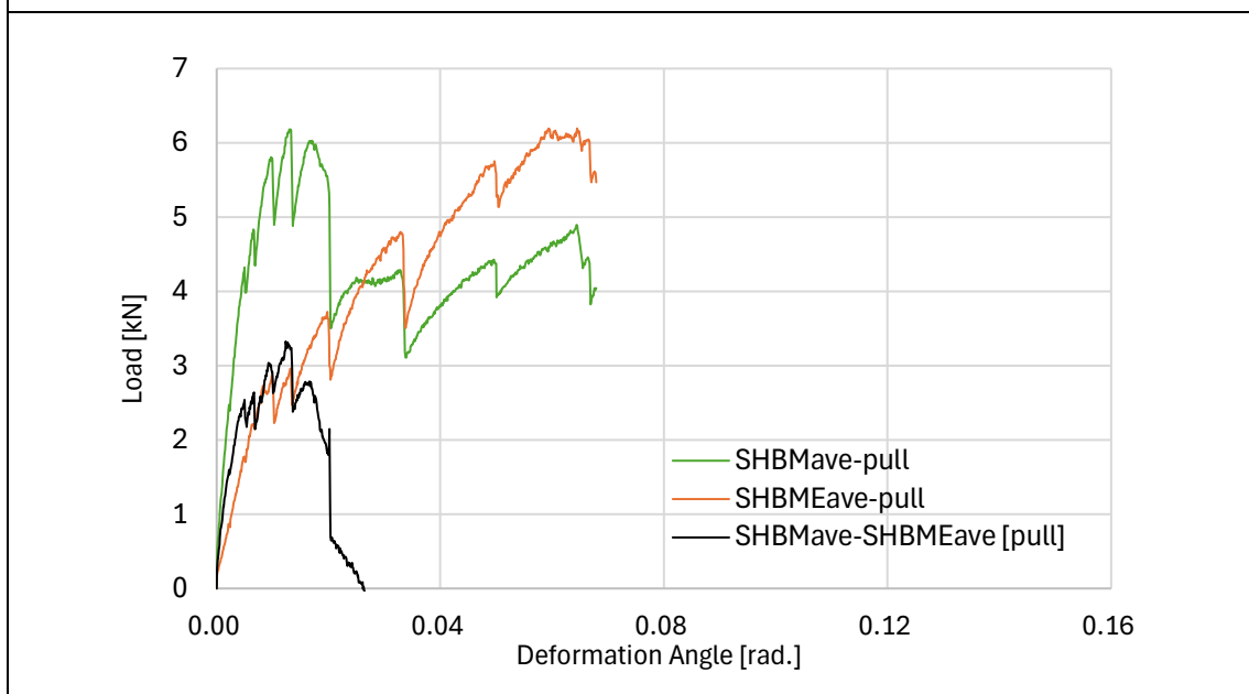
図 11：中塗り漆喰の平均曲線と中塗り漆喰 [縁なし] の曲線の差分 [中塗り漆喰の「縁部分があることによる」負担せん断力]
